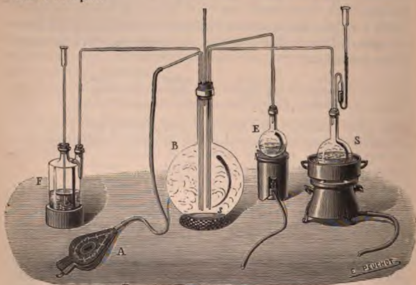
Fig. 80. — Préparation de l'acide sulfurique par l'acide sulfureux, l'air et les vapeurs nitreuses. (Démonstration de laboratoire.)
